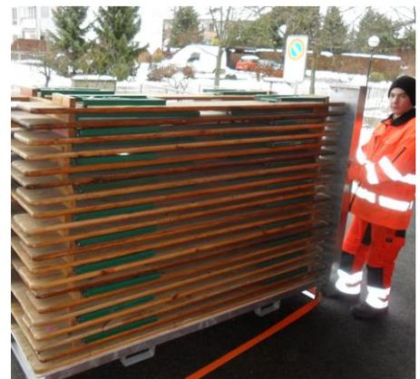
Abladung: Gurte lösen, die zwei nicht festgeschraubten Seitenwände (längs) wegnehmen, Festbänke entnehmen.
