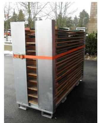
Aufladung: Zuerst die Festbänke stapeln und anschliessend die zwei Seitenwände einfahren und festzurren
