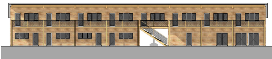
Ansicht von Norden oder vom Spielfeld auf die Garderoben, das «Clubhaus» und die Ateliers mit Laubengang
