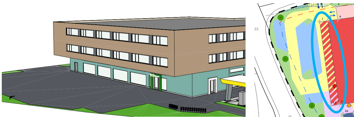
Abbildung 20: Auskragender Gebäudeteil gemäss Richtprojekt.
